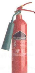
**Estintori a CO<sub>2</sub>** (anidride carbonica) lavorano sulla base di un principio completamente differente rispetto ai precedenti: invece di bloccare il fuoco creando una patina agiscono per mezzo della reazione chimica dell'anidride carbonica che "soffoca" l'incendio eliminando l'ossigeno che alimenta le fiamme. L'azione di pressione dell'impugnatura provoca l'espulsione del gas che, a contatto con l'aria raggiunge temperature estremamente basse (sotto i 50 CC).
