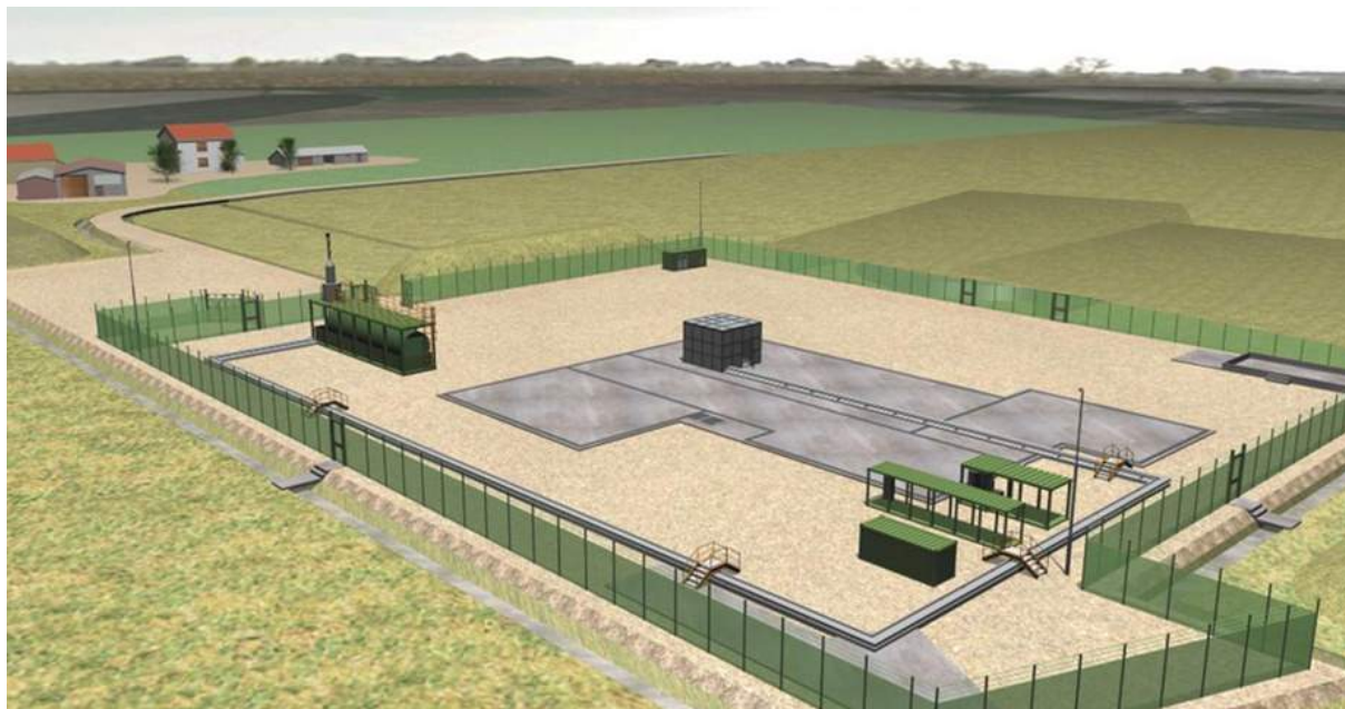
Figura B.4.1: Esempio di rendering di un impianto a gas nella fase di coltivazione (colorati in verde gli Skid).
