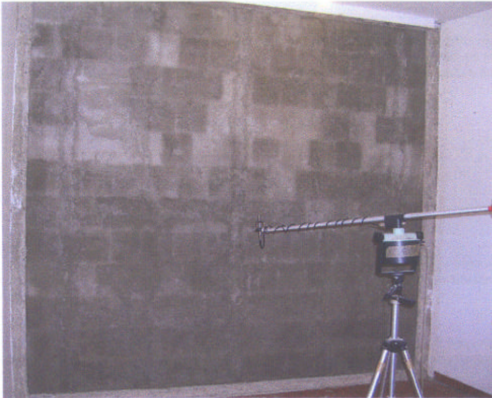
Fig.2 – Il campione in prova realizzato nella camera acustica visto da lato sorgente.
