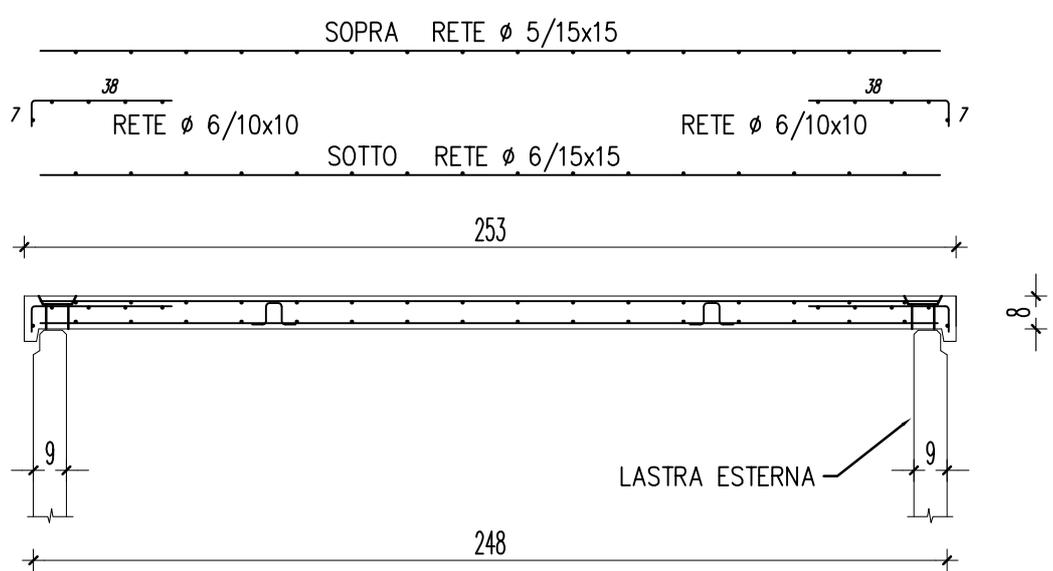
FISSAGGIO LASTRA ESTERNA SOLETTA DI COPERTURA
