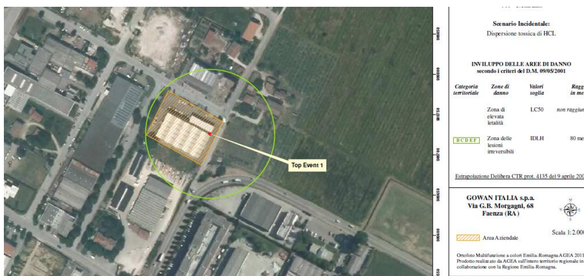
Stralcio Tavola "Evento incidentale con conseguenze esterne allo stabilimento e relative categorie territoriali compatibili"
