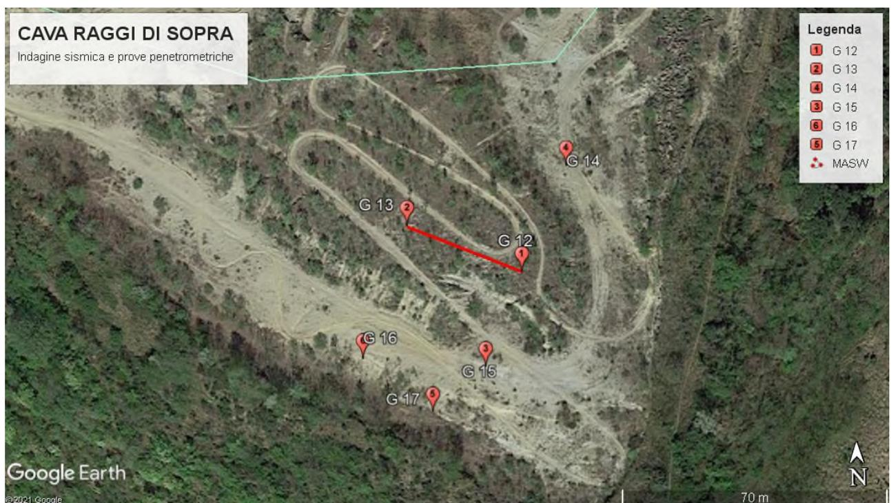
**Figura 3.** Ubicazione delle misure di microtremore sismico ambientale e MASW (sistema WGS-84).
