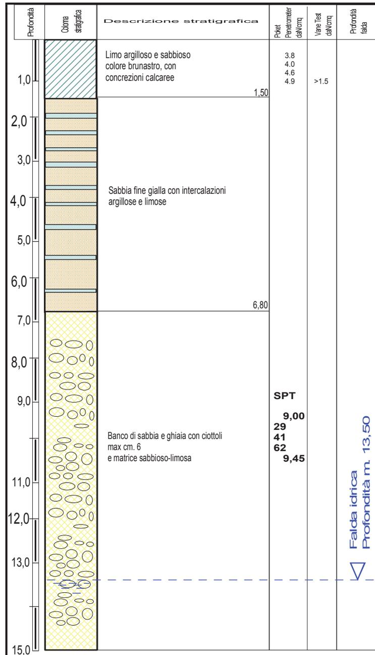
Al termine del sondaggio è stata verificata una presenza di acqua di falda nel foro con quota dal p.c.: **S1 = m. -13,50**.
