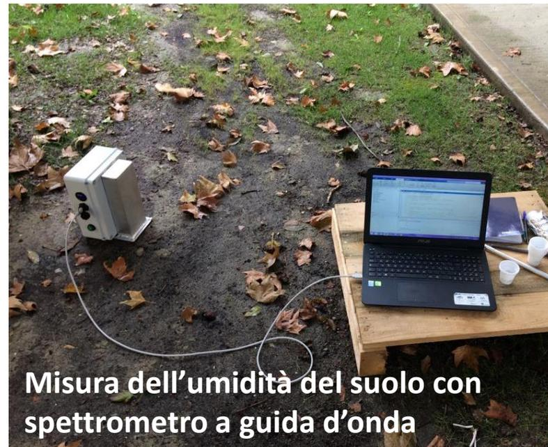
**Misura dell'umidità del suolo con spettrometro a guida d'onda**
