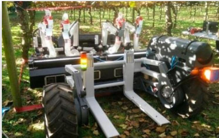
**Robot per la raccolta dei kiwi a multibraccio**, progettato per operare autonomamente nei frutteti con sistemazione a pergola. Il raccogliatore è costituito da quattro bracci robotici progettati specificamente per la raccolta dei kiwi, ciascuno con un nuovo *end-effector* (=pinza) sviluppato per consentire una raccolta sicura dei frutti.
