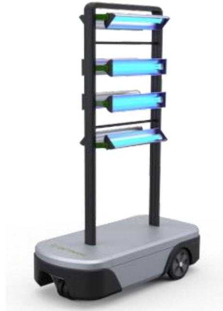
Le spore fungine vengono inattivate mediante un robot sperimentale autonomo, provvisto di **lampade UV-C**, finora testato su: fragole, lattuga, basilico, pomodori e cetrioli.
