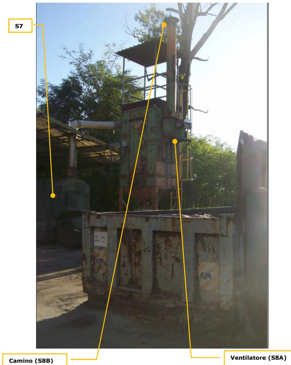
Durante il sopralluogo è stato possibile caratterizzare acusticamente solamente il ventilatore (S8A). Il camino (S8B) verrà stimato all'interno del modello di calcolo sulla base dei rilievi eseguiti al confine di proprietà ed ai ricettori sensibili e riportati all'interno della verifica di impatto acustico.
